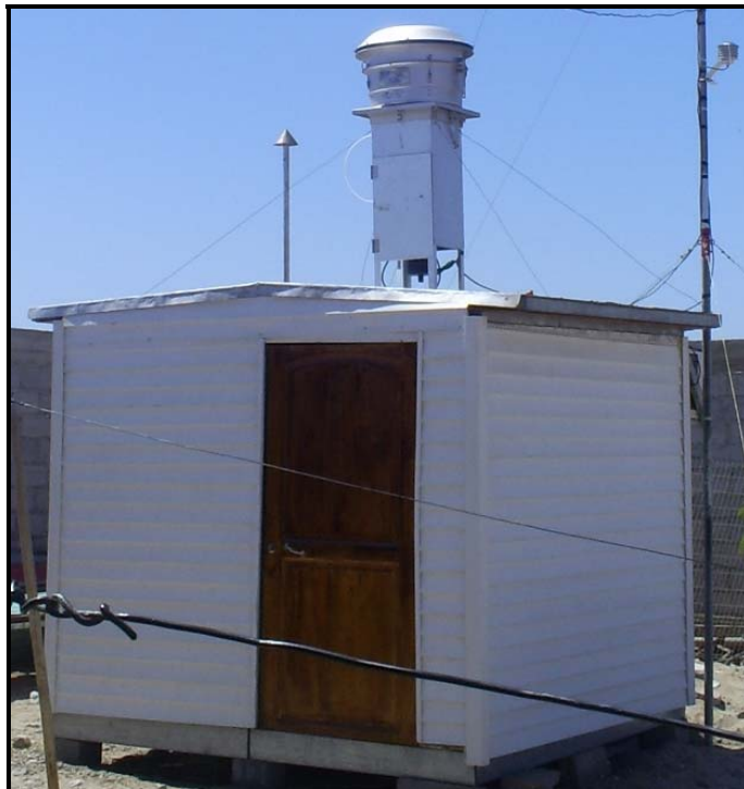
Fotografía N° 1 Muestreador de Material Particulado MP-10, Estación Caldera Norte
