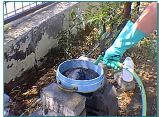
**Fotografía 5.4-7** Proceso de cernido de las muestras de sedimento.
