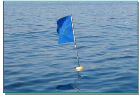
**Fotografía 5.4-3** Detalle de elemento derivador utilizado en la zona de estudio.
