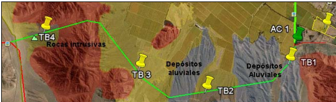
Figura 5.13-12 Tramo Línea Eléctrica 23 kV TB1 a TB2
