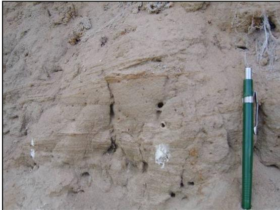
**Fotografía 5.4-11.** Arenas con estratificación cruzada de los Depósitos Fluviales finos (Qfb). Cauce del Río Copiapó en Estación Monte Amargo.
