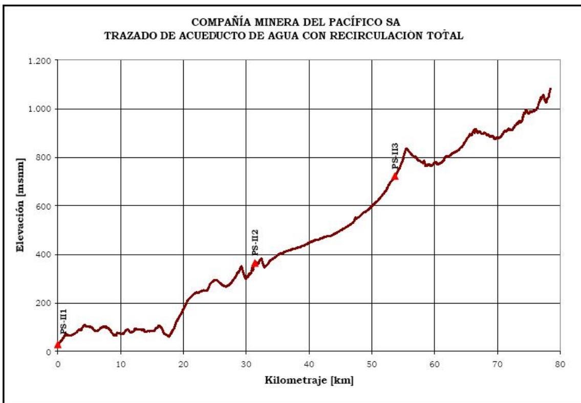
PS-III1: Estación de bombeo 1. PS-II2: Estación de bombeo 2. PS-II3: Estación de bombeo 3
