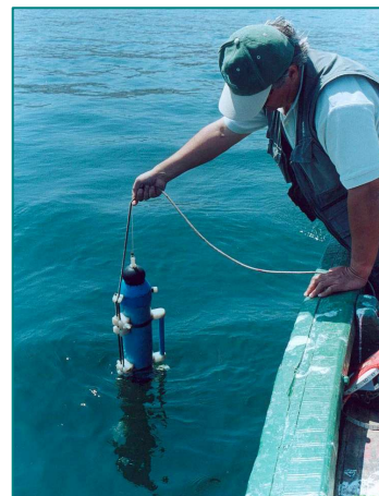
Fotografía 3.1. Inmersión de botella Niskin en la columna de agua de mar.
