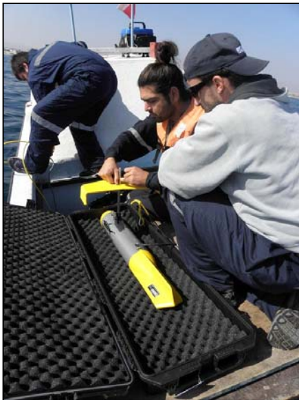
Fotos 3 – 4. Labores de armado y configuración de plataforma de rastreo del survey geofísico mediante sonar de barrido lateral.
