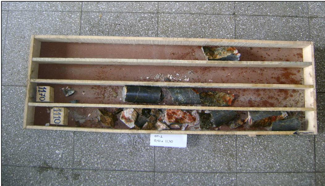
Figura 4: Sondaje ST-1 tramo 10,4 – 11,7 m.
