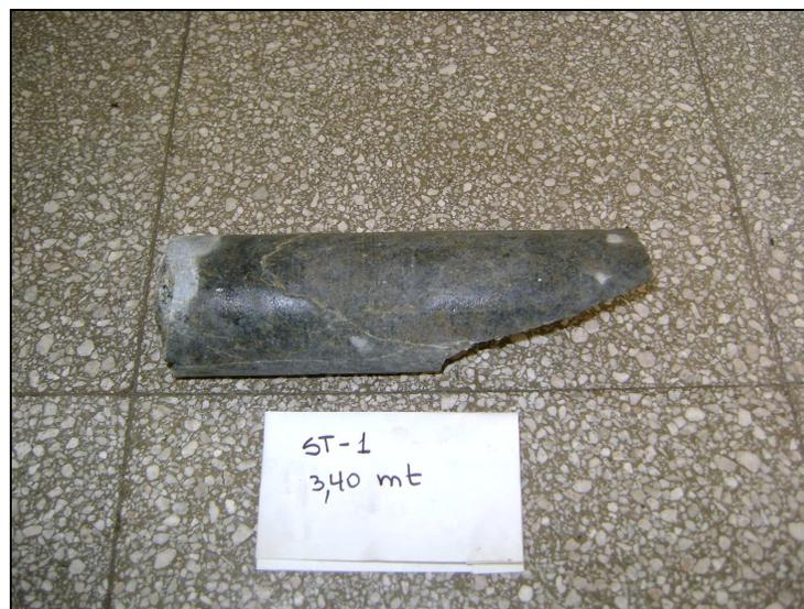
Figura 1: Muestra representativa sondaje ST-1
