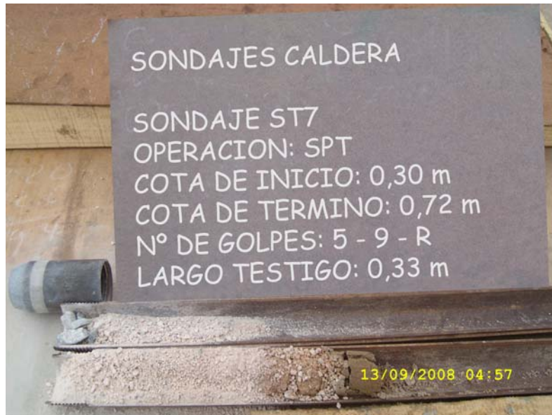
Fotografía 19: Muestra de SPT entre 0,30 y 0,72 m en Sondaje ST7
