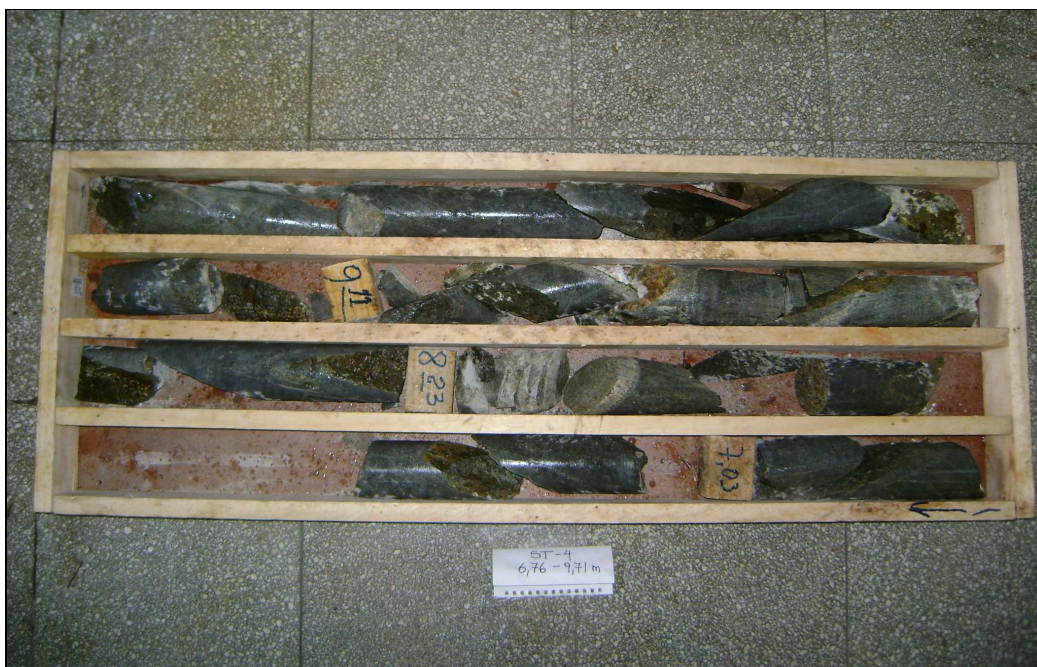
Figura 14: Sondaje ST-4 tramo 6,76 – 9,71 m.
