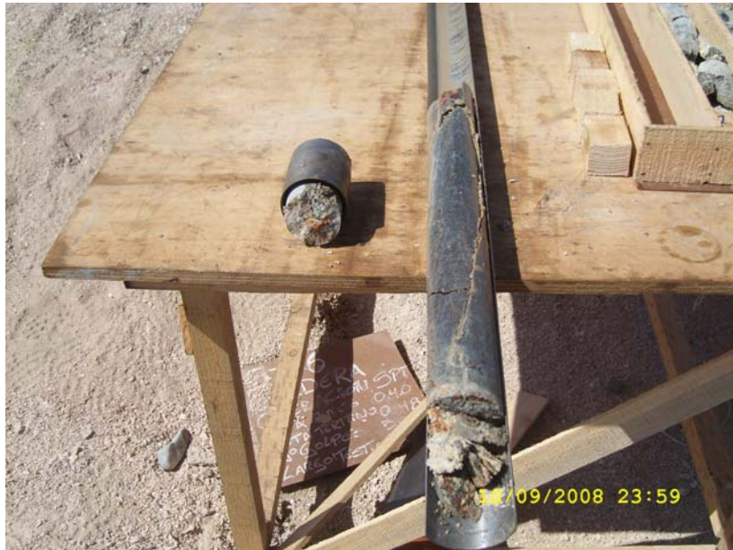
Foto N°3.3: extracción de lanas con muestras de roca, muestreo sistema HQ-3
