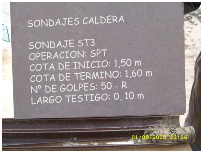
Fotografía 8: Muestra de SPT entre 1,50 y 1,60 m en Sondaje ST3
