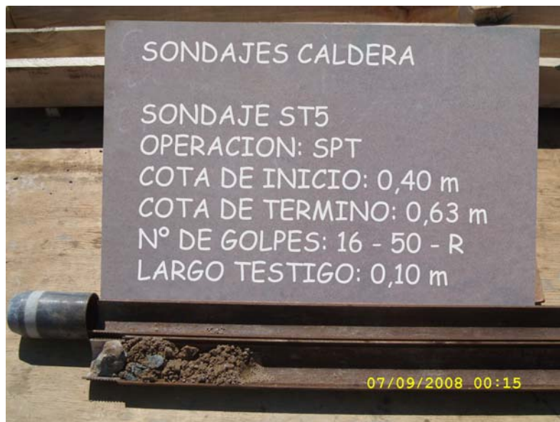
Fotografía 14: Muestra de SPT entre 0,40 y 0,63 m en Sondaje ST5
