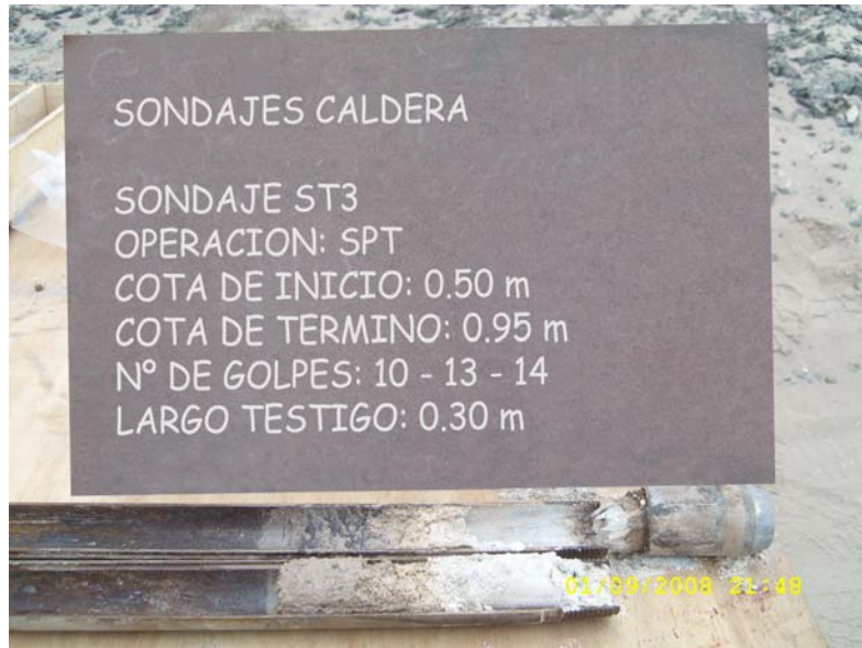
Fotografía 7: Muestra de SPT entre 0,50 y 0,95 m en Sondaje ST3
