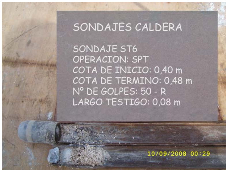
Fotografía 16: Muestra de SPT entre 0,40 y 0,48 m en Sondaje ST6
