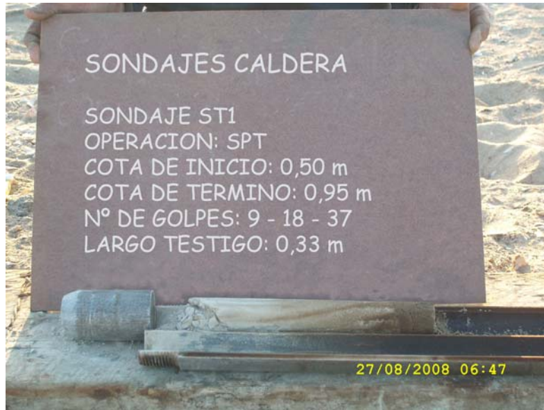
Fotografía 3: Muestra de SPT entre 0,50 y 0,95 m en Sondaje ST1
