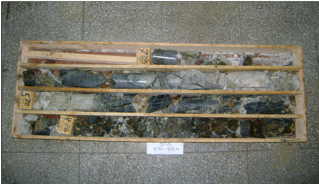
Figura 17: Sondaje ST-5 tramo 3,7 – 7,05 m.
