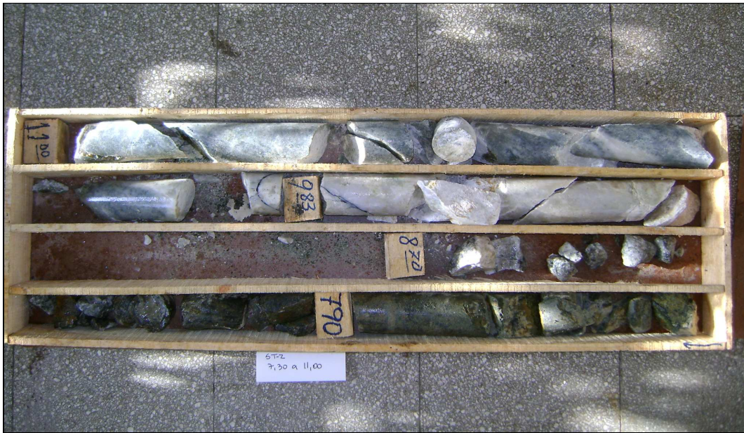
Figura 7: Sondaje ST-2 tramo 7,3 – 11,0 m.
