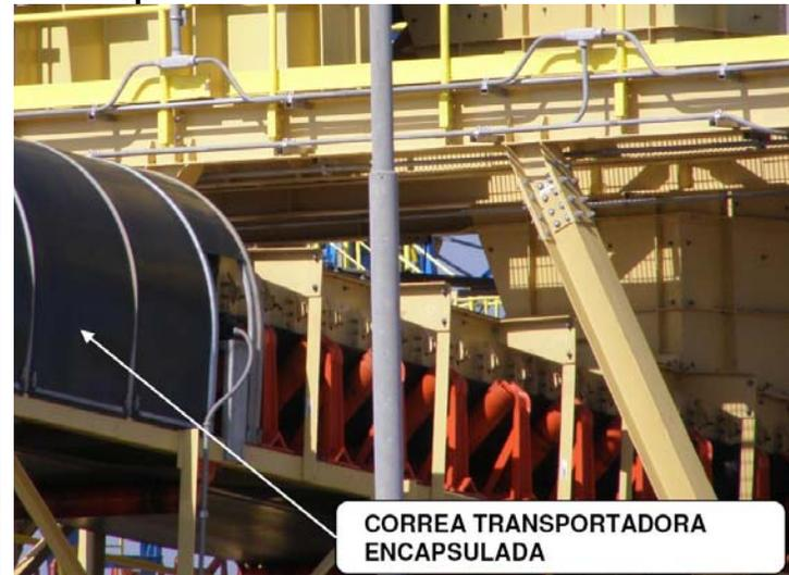
**Fotografía 2:** Vista Detalle Correas Transportadoras de Mineral Encapsuladas (materialidad removible)
