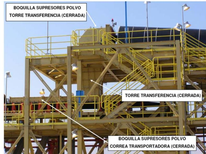
**Fotografía 4:** Torres de Transferencia cerrada con los equipos Supresores de Polvo. Tal como se observa el proceso se realiza en un sistema aislado del exterior.
