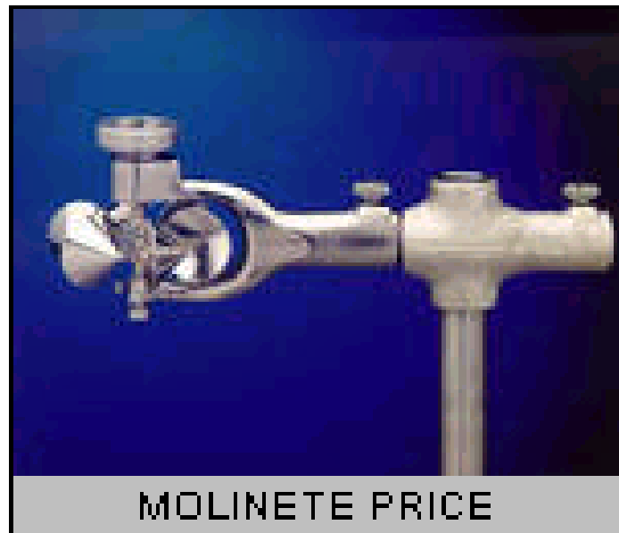
Figura N°6.2 Molinete Tipo Price. Cazoleta, utilizado por la D.G.A.
