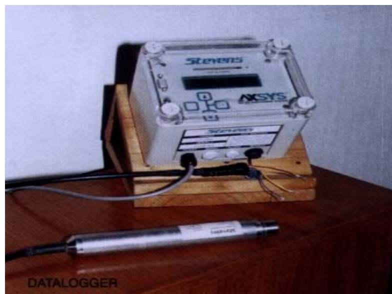
Figura N° 7.2. Limnógrafo Digital. Data Logger.
