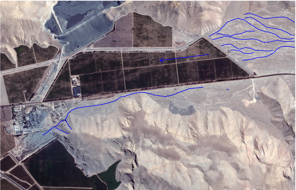
Fig. 4.39: Las líneas azules indican los canales de drenaje natural del sector que se puede identificar en la imagen satelital y/o por observación en terreno. La flecha azul indica la probable dirección general del cauce natural de la quebrada, donde no es posible observar canales de drenaje natural.
