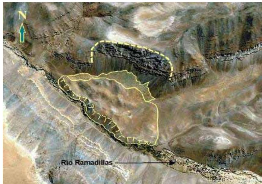
**Fotografía Nº 3.6.** Probable Deslizamiento antiguo en la ladera norte del río Ramadillas. La línea punteada marca el lugar desde donde se habría desplazado el material. Obsérvese la superficie superior ondulada característica de remoción en masa. En punteado amarillo se destaca el área afectada por caída de rocas actualmente.
