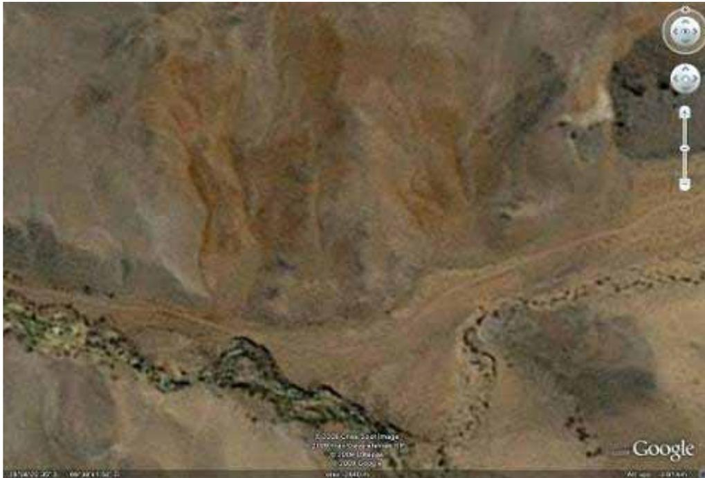
**Fotografía N° 6.7.** Vista del flujo de detritos de la quebrada La Brea y su acción sobre el curso del río Ramadillas. En el segundo plano de la fotografía se observan los nichos de despegue de antiguos derrumbes.
